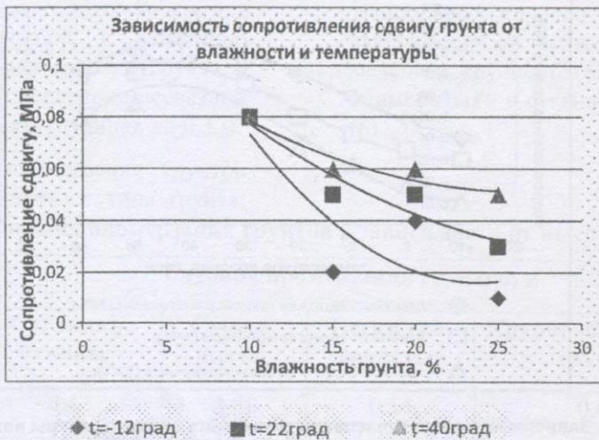
Рис. 4. График зависимости сопротивление сдвига грунтов от влажности и температуры.
